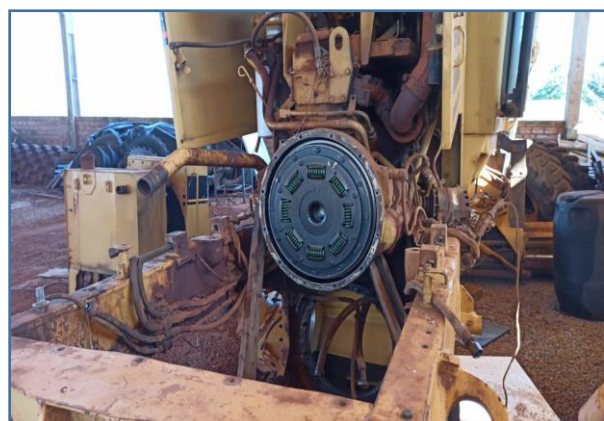
IMAGEM TRASEIRA DO EQUIPAMENTO COM O MOTOR E TRANSMISSÃO JÁ DESMONTADOS
