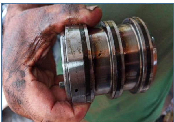
ANÉIS CÓDIGO 7G-4822 QUE PRECISAM SER SUBSTITUÍDOS
