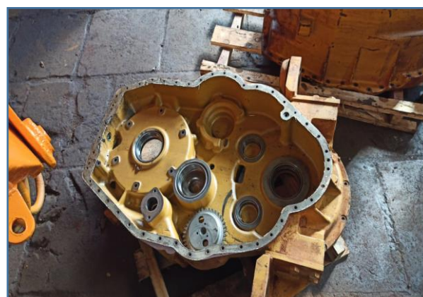
CARÇA DA TRANSMISSÃO DESMONTADA
