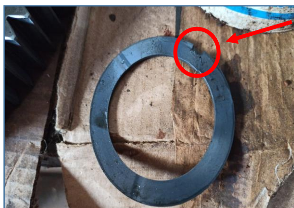
ANEL DE VEDAÇÃO DANIFICADO
