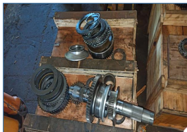
INTERNOS DO PACOTE DE TRANSMISSÃO DESMONTADOS
