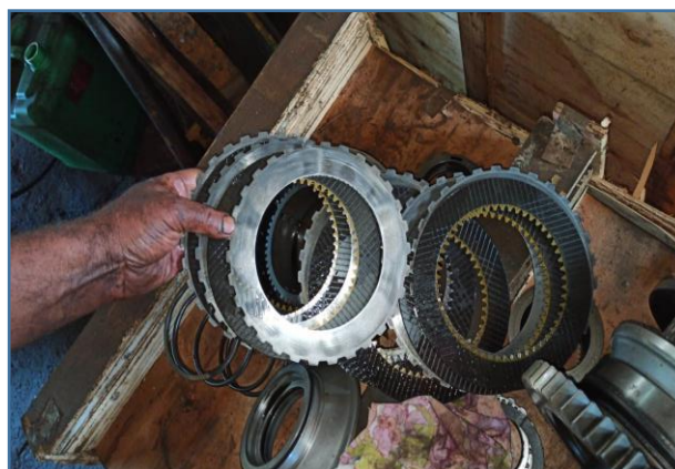
INTERNOS DO PACOTE DE TRANSMISSÃO DESMONTADOS
