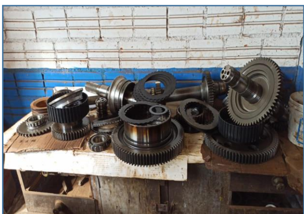
INTERNOS DO PACOTE DE TRANSMISSÃO DESMONTADOS
