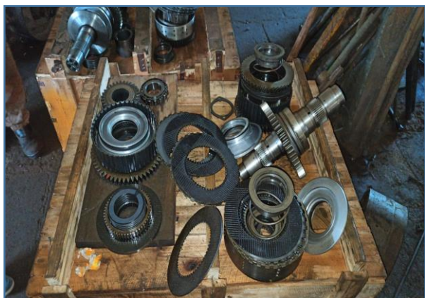
INTERNOS DO PACOTE DE TRANSMISSÃO DESMONTADOS
