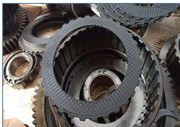
DETALHE DE DISCO BEM DANIFICADO
